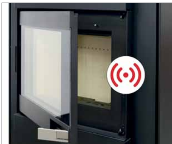
SENSORE ACUSTICO APERTURA PORTA Garantisce una migliore sicurezza di funzionamento della stufa. Con funzionamento a legna all'apertura della porta la serranda si apre automaticamente evitando l'uscita dei fumi nell'ambiente, con quello a pellet in caso di apertura della porta, la stufa si spegne automaticamente.
